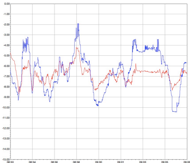
Figure 9 Thermal Inclinometer RED, Pendulum inclinometer BLUE
